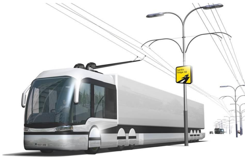
Figur 1. Bilden visar ett framtida transportfordon som kör uppkopplat mot en elektrifierad vägsträcka. Bilden är framtagen av Svenska Elvägar AB som huvudansvarig för projektet "Elektriska vägar" med flera parter inblandade.
