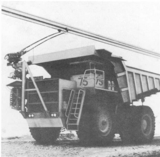
Bild 2. Trollestängerna anslutna till skenan.
