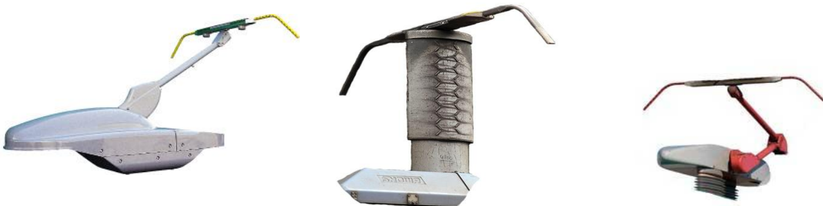
Bild 10. Tre varianter på japanska Shinkansens strömavtagare.
